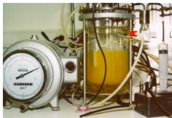
Thermofiele omzetting van suiker in waterstof, kooldioxide en azijnzuur door Thermotoga elfii bij 65 °C.
